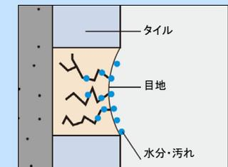
目地はセメント基材なので、ひび割れが生じ、
